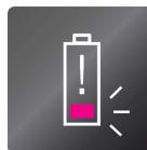
**Alarma de batería baja a 10,5 V y desconexión por batería baja a 10,0 V**
